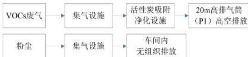
图3-3 项目废气处理工艺流程
