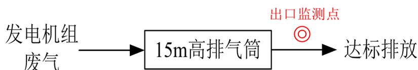
图 4-2 发电机组废气处理工艺流程图
