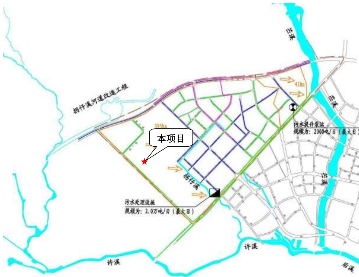
图 2-5 规划区污水汇水划分示意图
