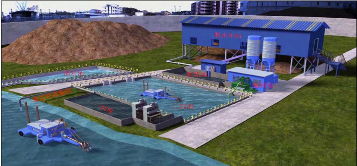
图 2.1-19 脱水固化处理站典型布置图
