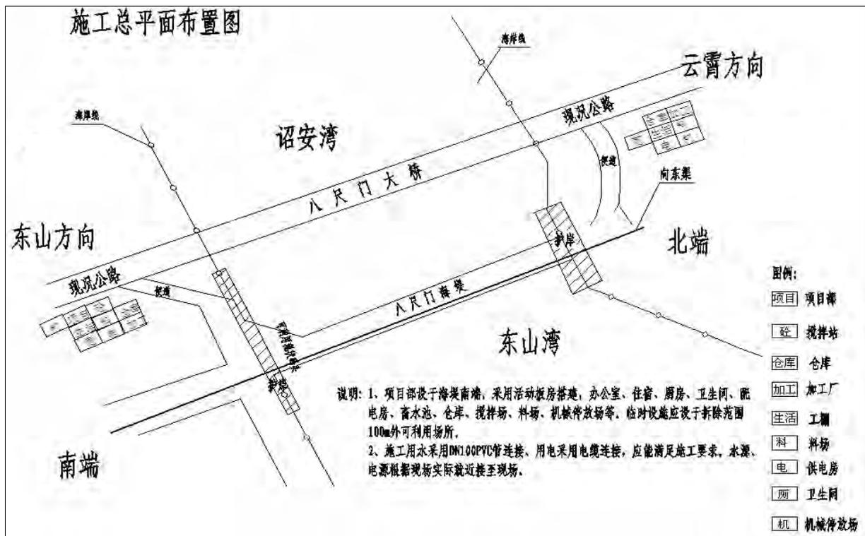
图 2.1-18 本项目施工平面布置图
