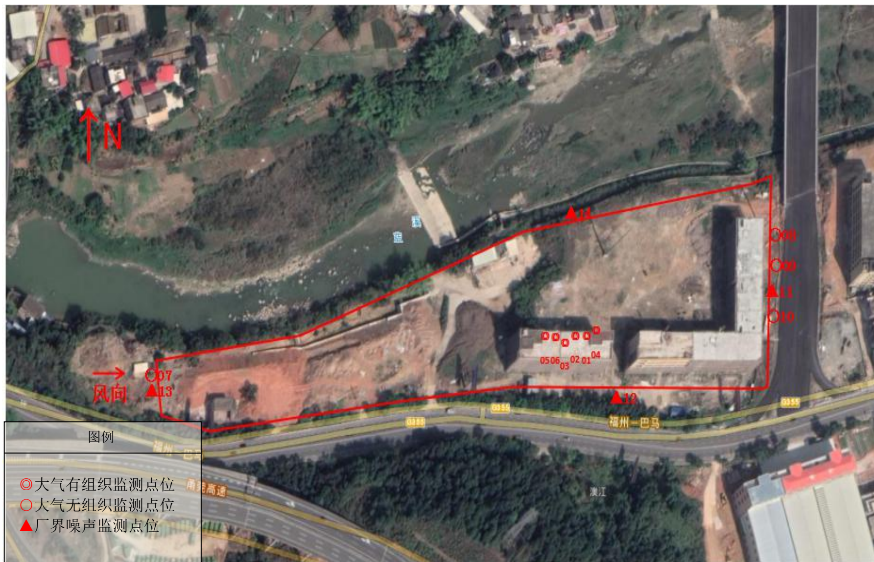
图 7-2 项目排气筒位置、无组织监测点位、厂界噪声监测点位平面示意图
