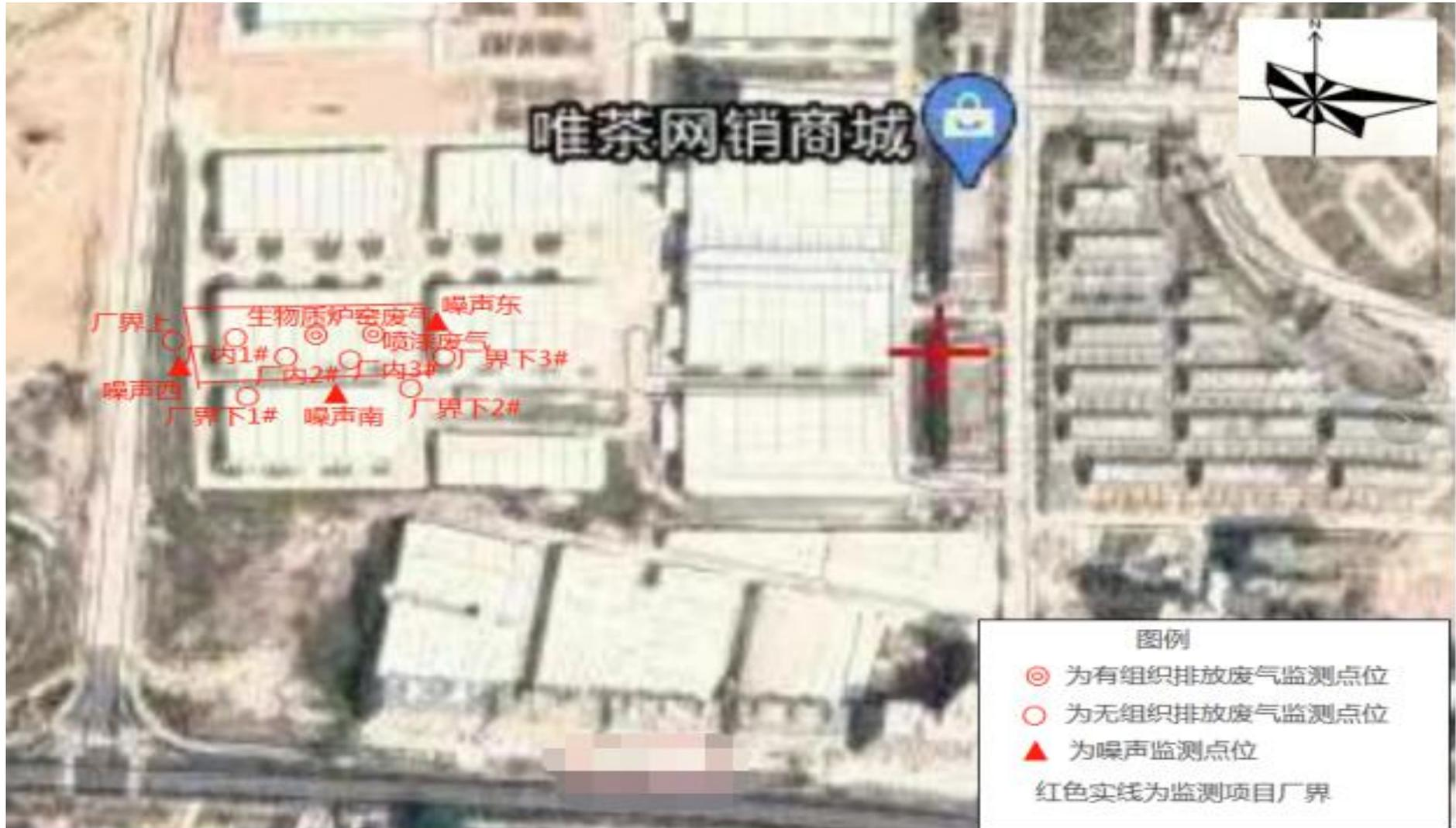
图 7-2 项目生产废水、废气有组织、无组织监测点位、厂界噪声监测点位平面示意图
