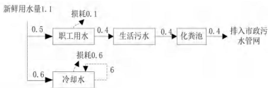
图 2-1 项目水平衡图（单位：t/d）
