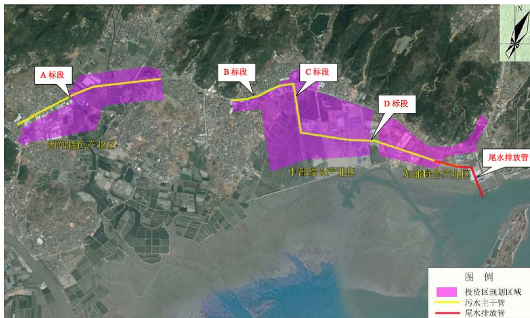
图 4.2-1 元洪污水处理厂一期的管铺情况图
