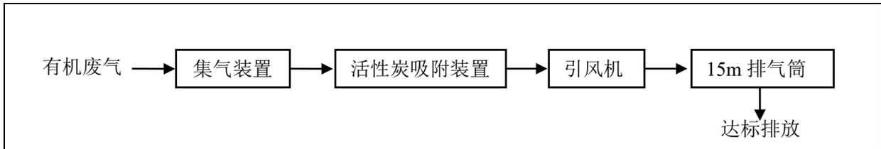
图 5.1-1 项目有机废气处理流程图
