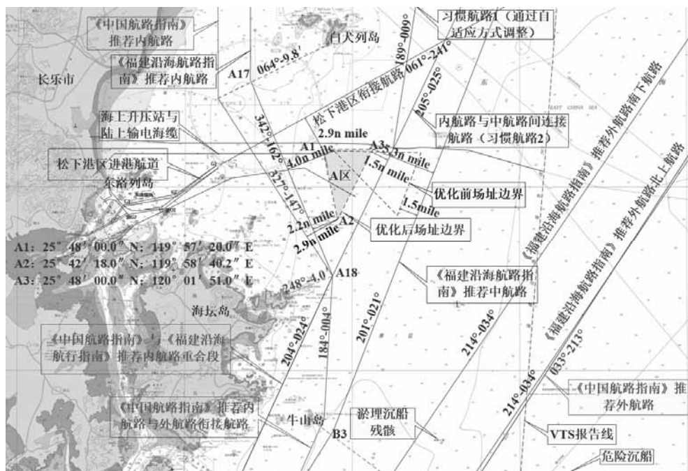
图 3a 2019 年通航安全分析优化方案与福建省沿海推荐航路、习惯航路位置关系图
