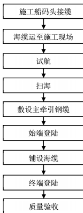
图 2.3-6 海缆敷设施工工艺
