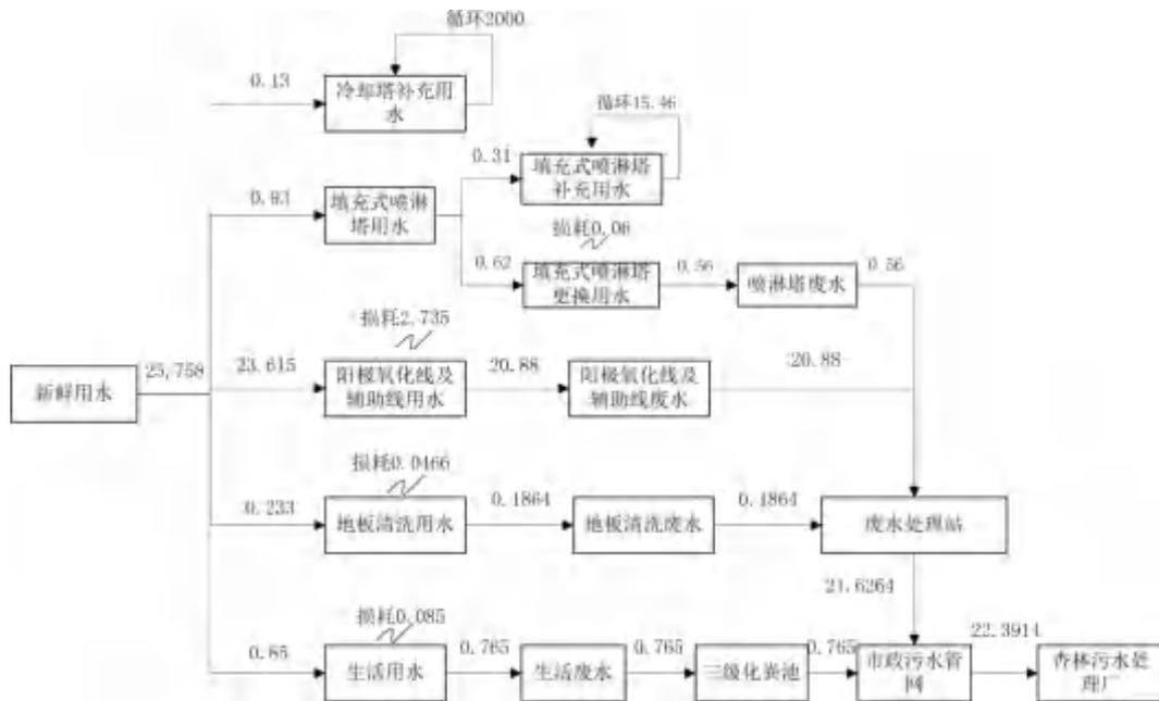
图 2-1 项目水平衡图 (单位: t/d)
