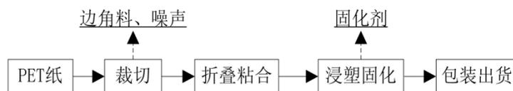
图 3.3-2 折纸滤芯生产工艺流程及产污环节图
