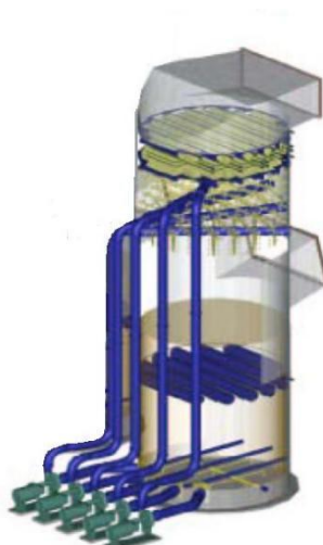
图 4-13 项目脱硫吸收的空塔喷淋吸收塔
