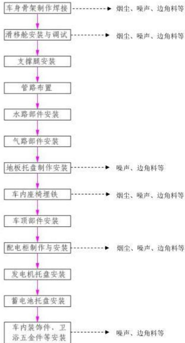
图 3.3-8 机装车间生产工艺流程图
