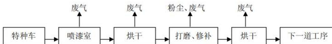
图 3.3-5 特种车涂装车间工艺流程图
