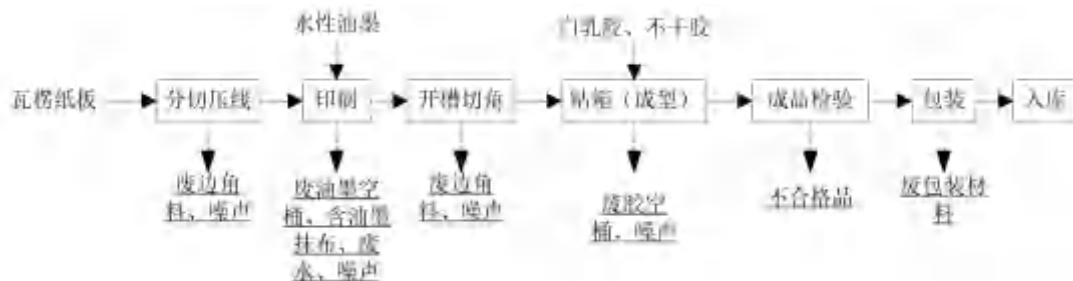
图 2.4-1 瓦楞纸箱生产工艺流程图及产污环节
