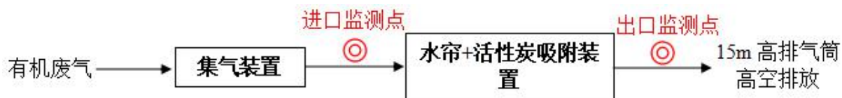
图 4-2 喷漆及烘干废气处理工艺流程图
