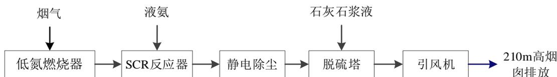
图 7.2-1 废气处理工艺流程图
