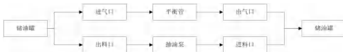
图 3.1-3 装卸废气处理工艺流程图
