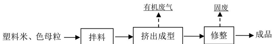
图 2-4 项目厨卫塑料制品生产流程及产污节点
