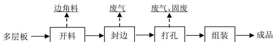
图 2-6 项目浴室柜生产流程及产污节点
