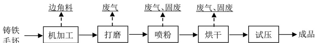
图 2-3 项目消防阀门生产流程及产污节点
