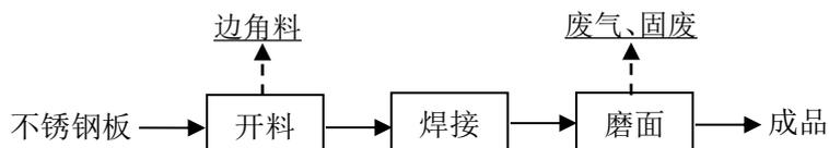
图 2-5 项目水槽生产流程及产污节点
