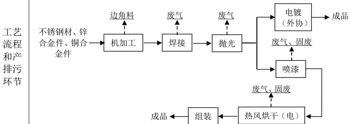
图 2-2 项目水暖配件生产流程及产污节点
