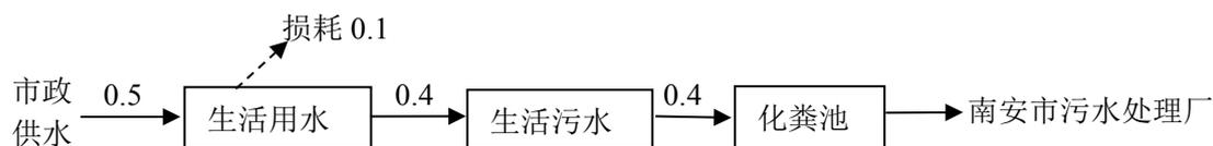
图 3-1 项目水平衡图 (m<sup>3</sup>/d)
