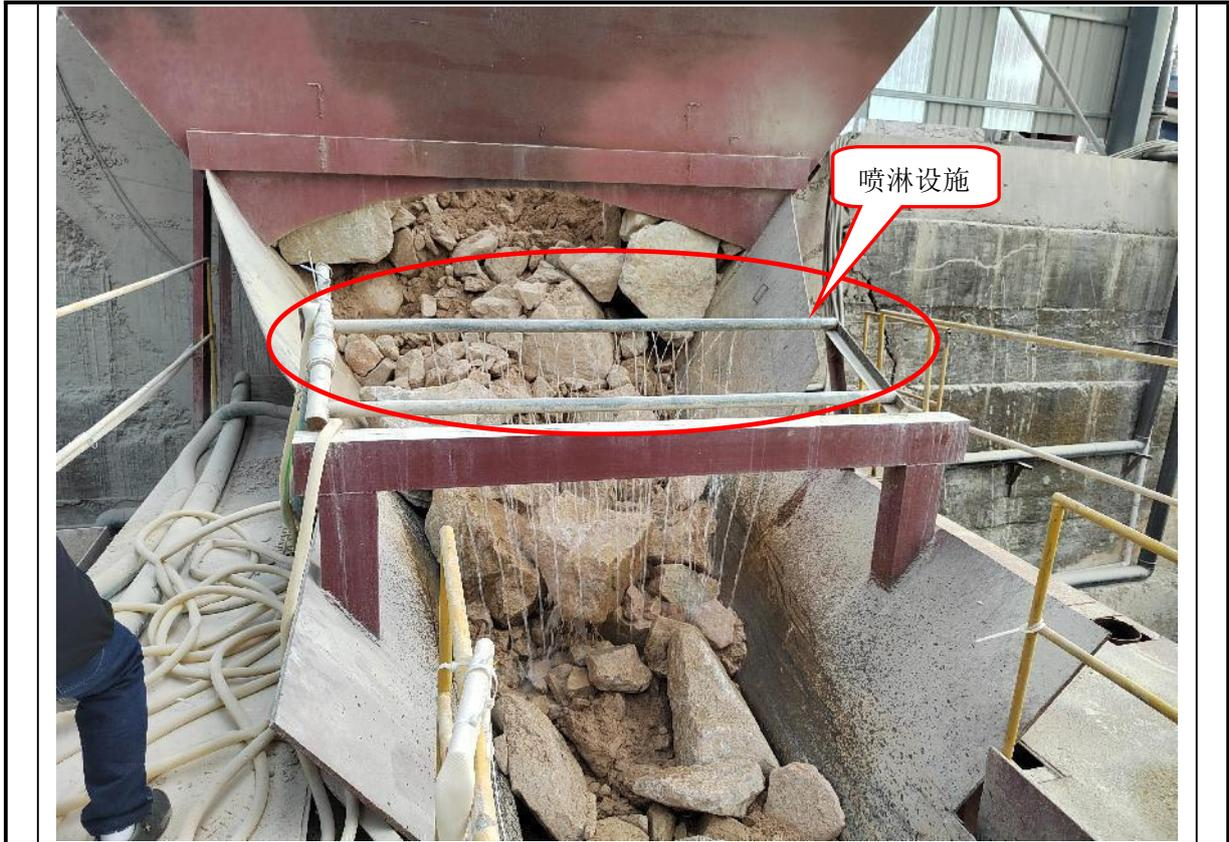
图片 2 破碎工序喷淋设施
