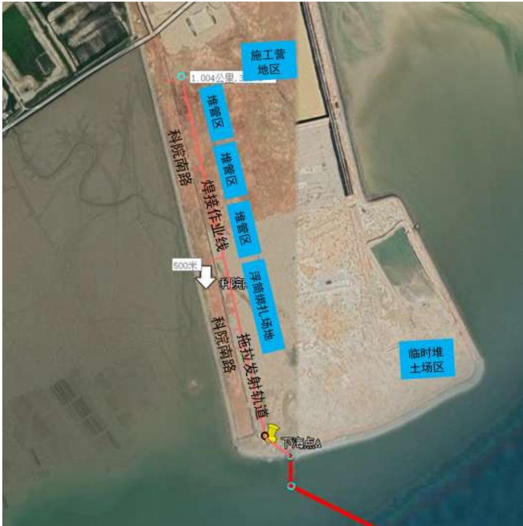
图 2.3-15 临时施工场地布置示意图
