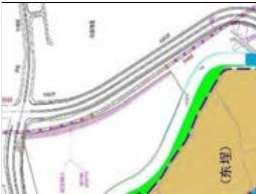
图 2.5-11 大嶧端施工便道
