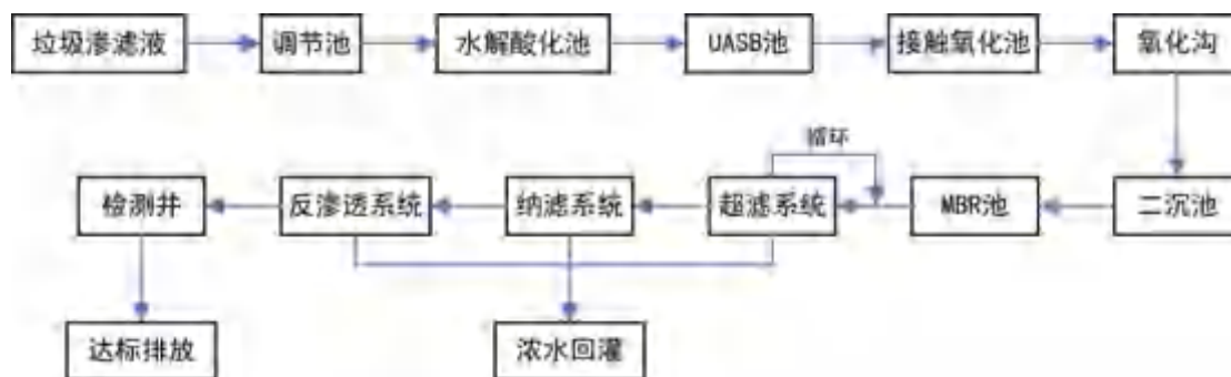
图 3.11-1 垃圾渗滤液处理站工艺流程图
