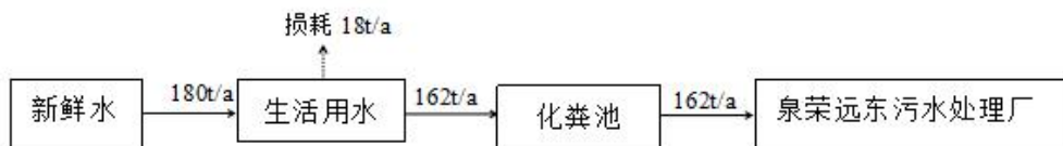
图 3-1 项目水平衡图
