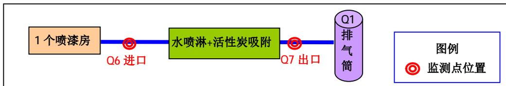
图 4-3 项目废气处理工艺流程图
