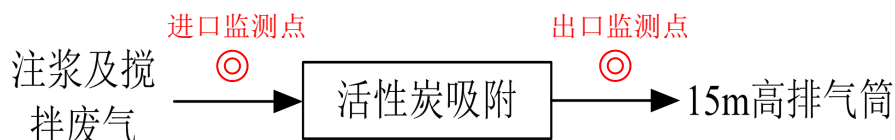
图 4-3 注浆及搅拌废气处理工艺流程图
