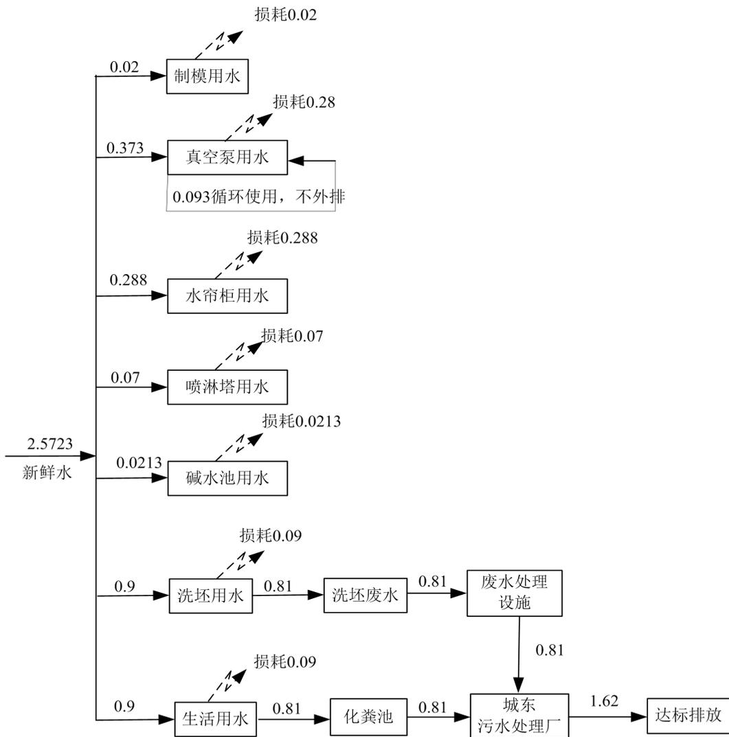
图 3-1 项目水平衡图 (单位: t/d)
