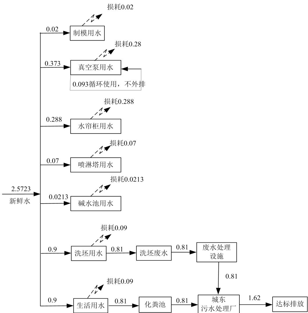
图 3-1 项目水平衡图（单位:  $\text{t/d}$ ）
