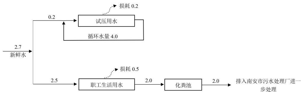
图 2-3 水平衡 单位： $\text{m}^3/\text{d}$
