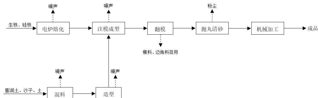
图 2-5 捷能公司原生产工艺流程图
