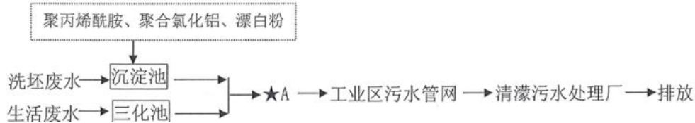
图 3-1 项目污水处理流程示意图
