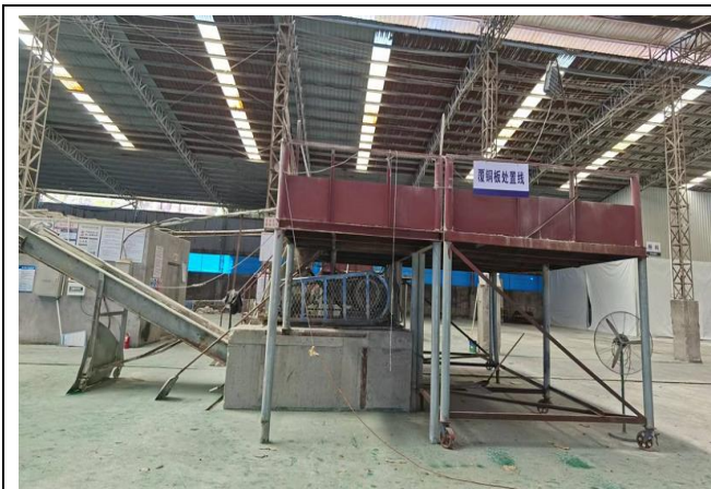
覆铜板基板废料粗破
