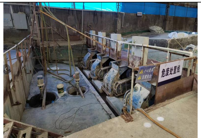
电路板废料细破
