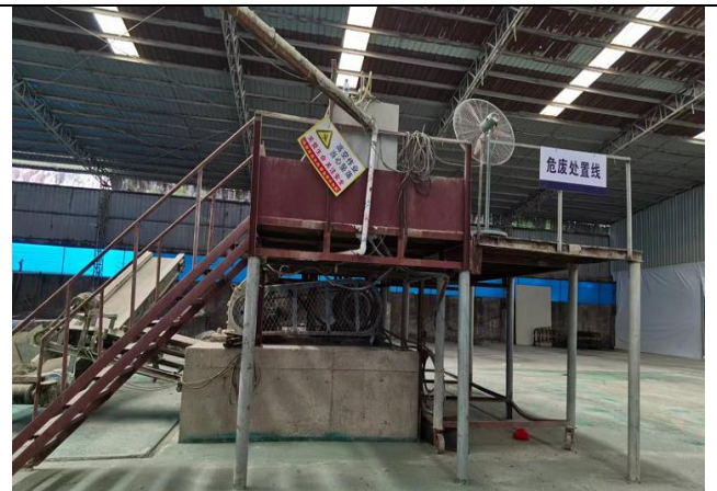
电路板废料粗破
