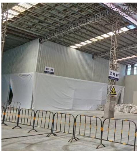
对原料进行分类堆放并设栅栏，原料使用编织袋，并贴上标识标签等
