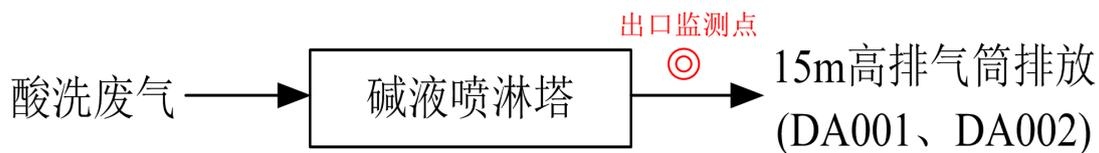
图 4-4 酸洗废气处理工艺流程图
