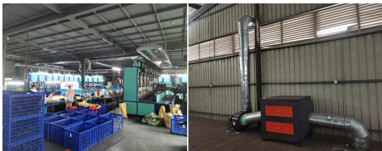
图 3-1 射出成型机集气罩及活性炭吸附装置
