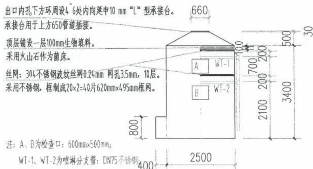
图 6-1 生物除臭装置结构示意图
