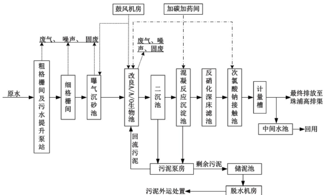
图 4-3 长泰县银塘污水处理厂工艺流程框图
