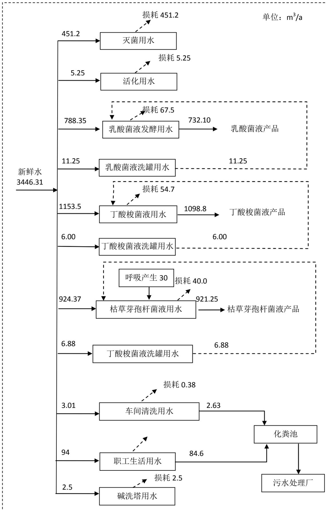
图 2-10 项目扩建工程水平衡图
