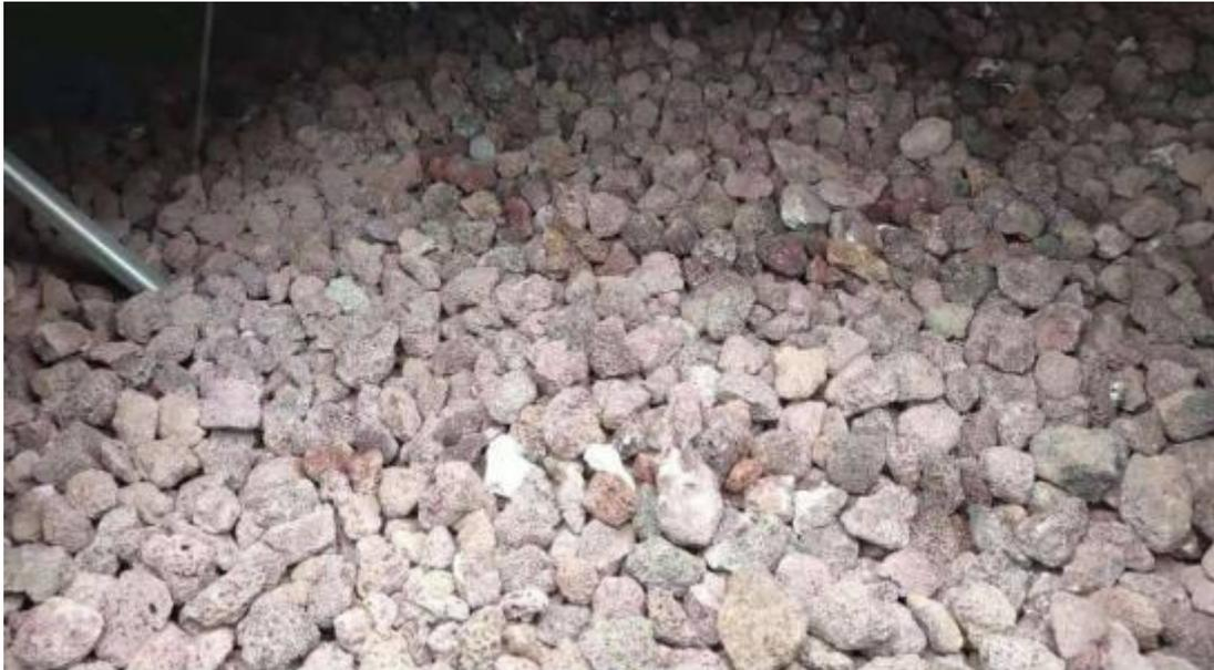
图6-2 生物除臭装置采用的火山石填料照片
