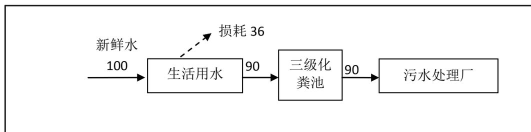
图 2-9 现有工程水平衡图
