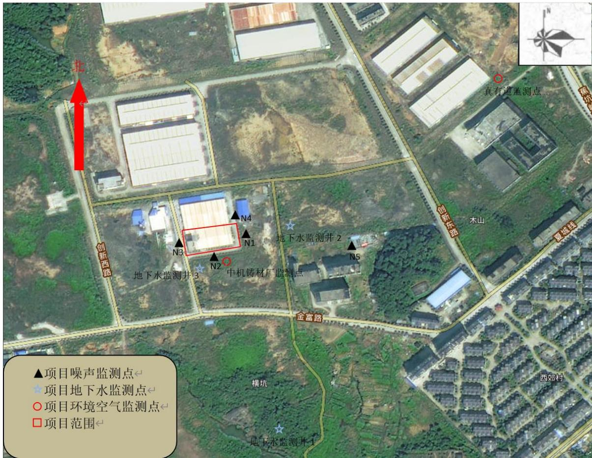
图 3.4-1 本项目大气、地下水、噪声监测点位图
