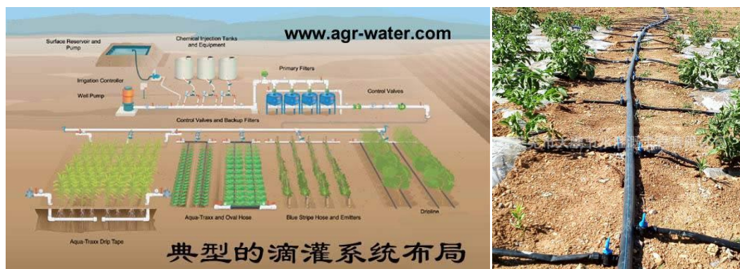
图 5.3-1 滴灌系统示意图
