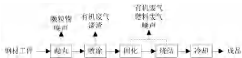
图 2.4-2 达克罗喷涂表面处理工艺流程图及产污环节
