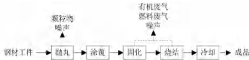
图 2.4-1 达克罗涂覆表面处理工艺流程图及产污环节
