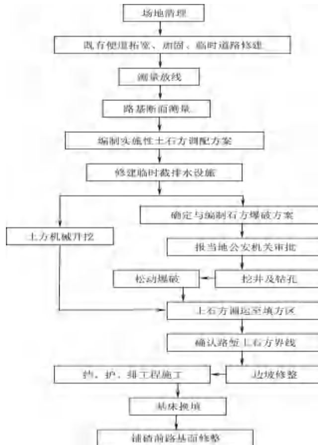
图 3.6-2 挖方路基施工工艺流程图
