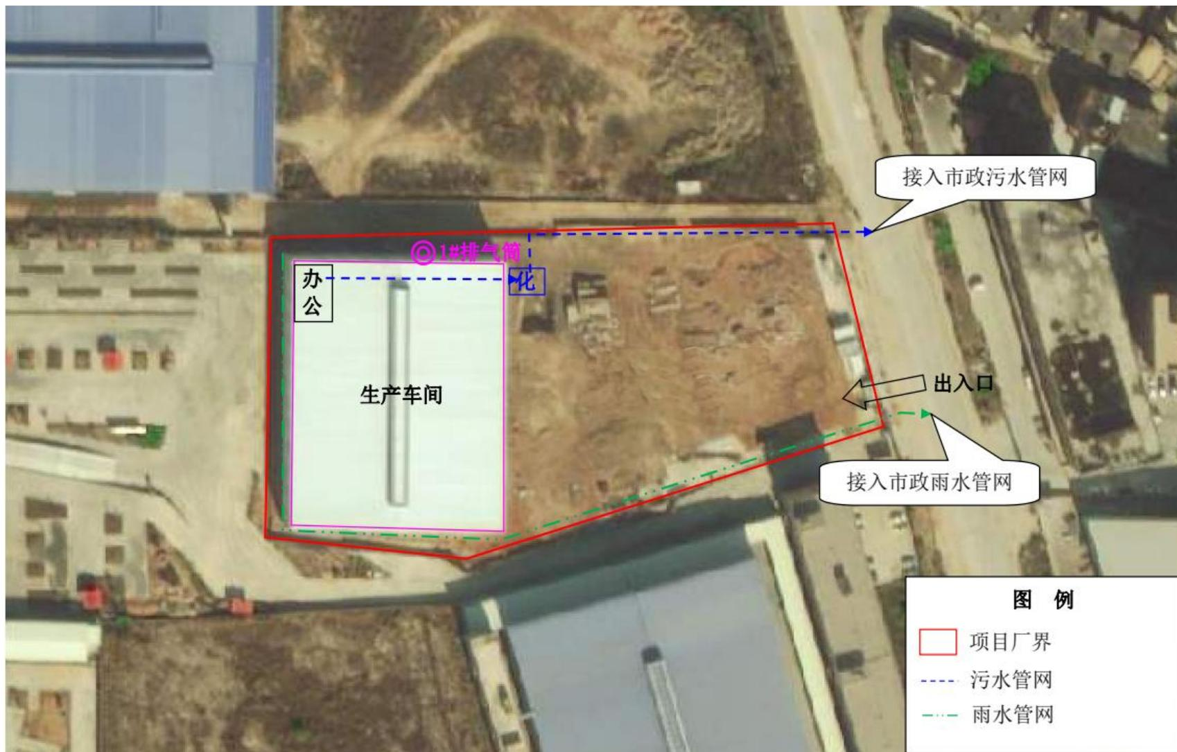
附图 3、厂区雨污管网分布图
