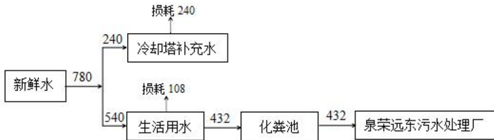
图 2.2-1 项目水平衡图 (单位: t/a)
