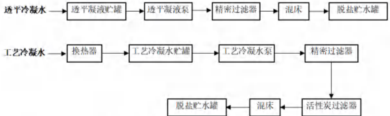
图 3.5-2 蒸汽冷凝水回收系统生产工艺图
