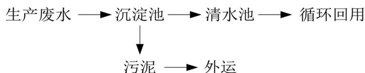
图 4-1 生产废水处理设施工艺流程图
