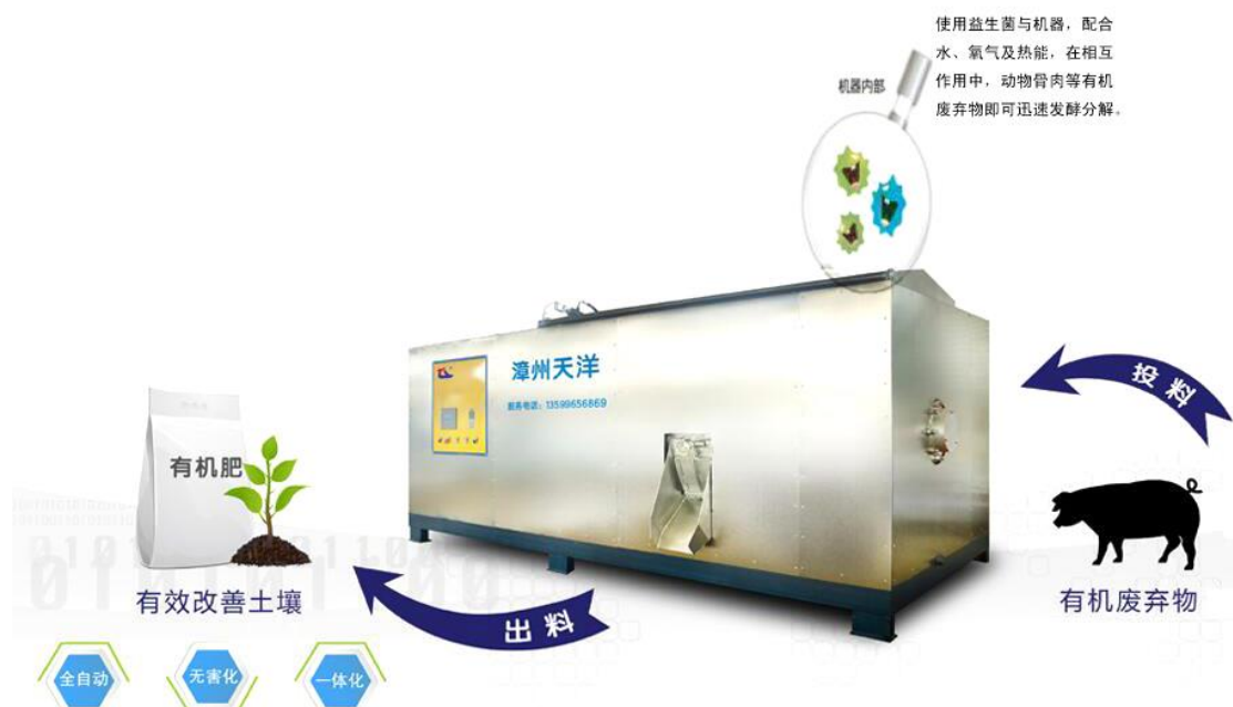
图 6-2 畜禽养殖场无害化降解机处理流程
