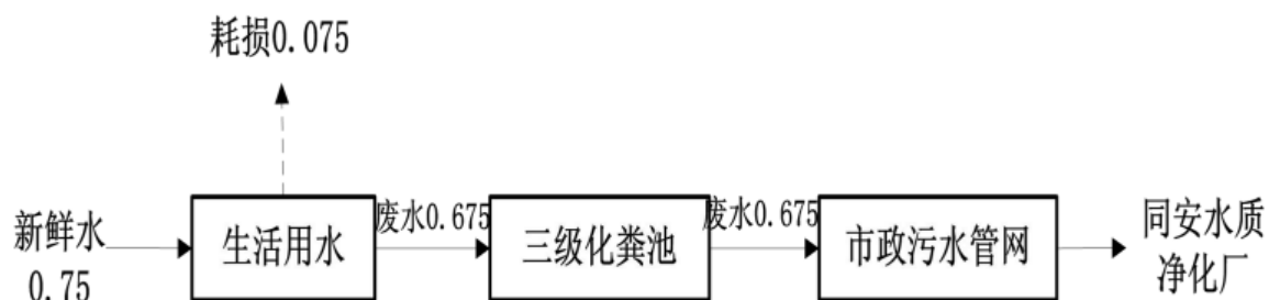
图 2-4 项目实际运行的水量平衡（单位：t/a，排污系数按 0.9 计算）
