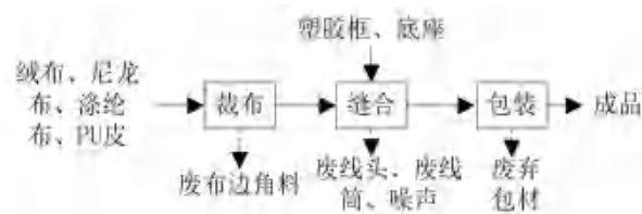
图 2.4-2 球包、球头帽套生产工艺流程及产污环节图
