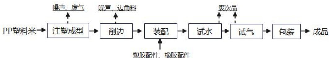
图 2-4 PP 水箱及水箱配件生产工艺流程图
