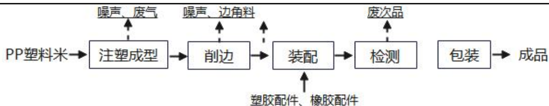
图 2-3 PP 盖板生产工艺流程图
