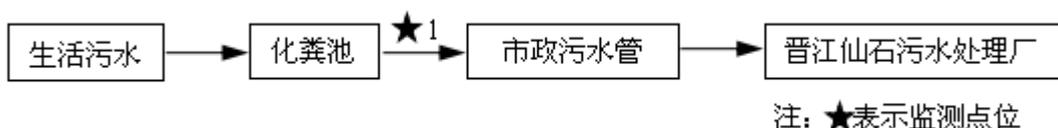
图 4-1 废水处理工艺流程图
