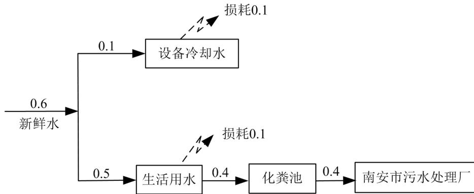
图 3-1 项目水平衡图 ( $\text{m}^3/\text{d}$ )
