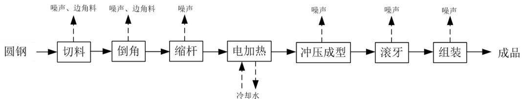
图 3-2 生产工艺流程及污染物产生环节
