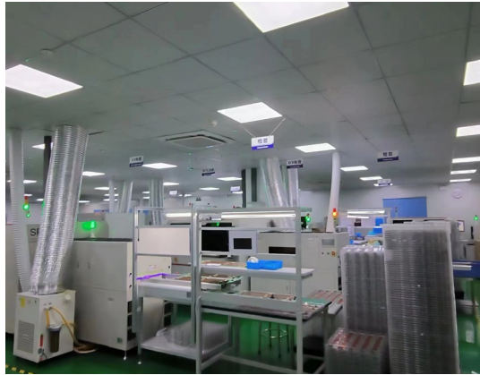
回流焊、点胶工序集气设施
