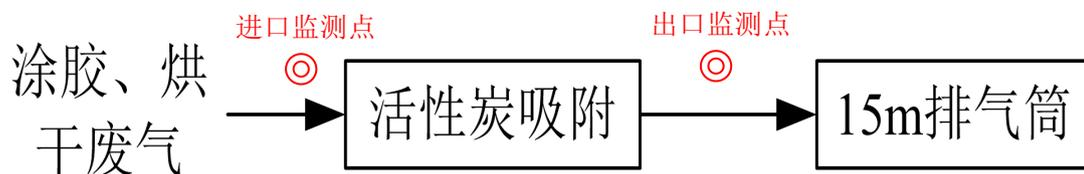
图 4-2 涂胶、烘干废气处理工艺流程图
